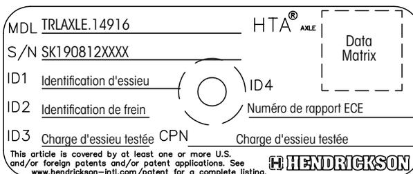
Située sur la patte intérieure (ou extérieure) du support du récepteur de freinage (pneumatique).
