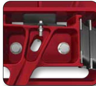
*Au fur et à mesure que la charge utile augmente et que le centre de gravité du véhicule augmente, le ressort à charge progressive se comprime et augmente la rigidité pour fournir une stabilité supplémentaire sans changements brusques du comportement.*
