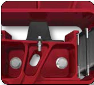
*À vide, la suspension repose principalement sur les ressorts de cisaillement diagonaux en caoutchouc qui aident à absorber les forces de la route et les chocs avant-arrière pour une confort de roulement exceptionnelle.*
