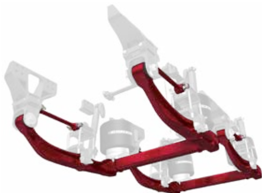
Système de stabilisation
