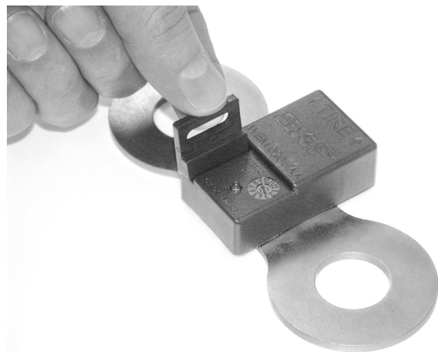
Figure 6: Utilisation de l'aimant pour vérifier la condition des roulements
